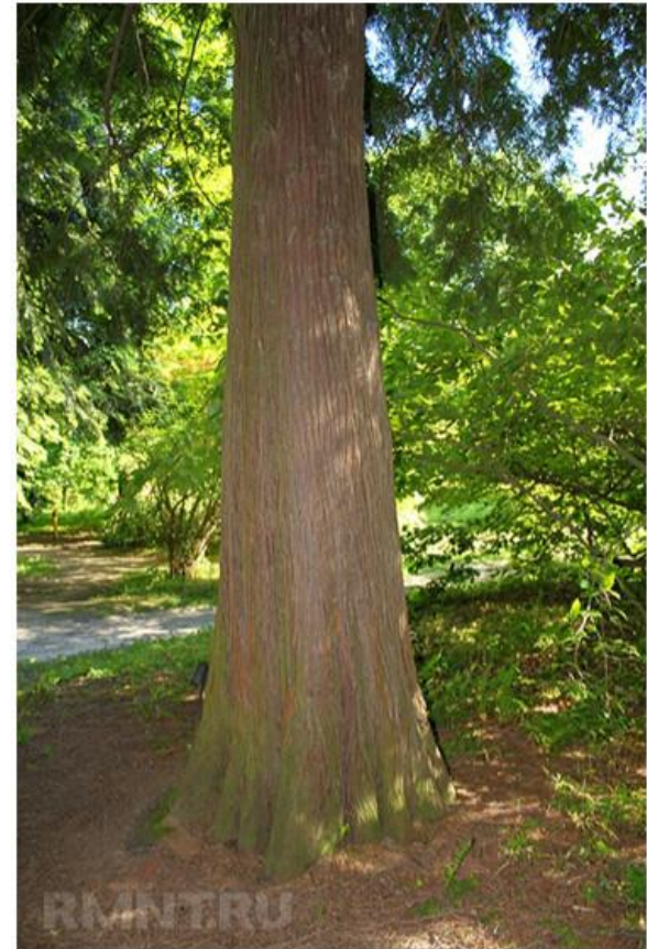
Сбежистость (постепенное уменьшение диаметра круглых лесоматериалов (или ширины необрезных досок) на всем их протяжении)
